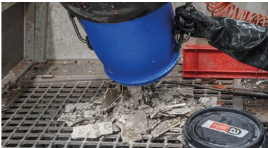
Leerung des Fasses über dem Vorrost
